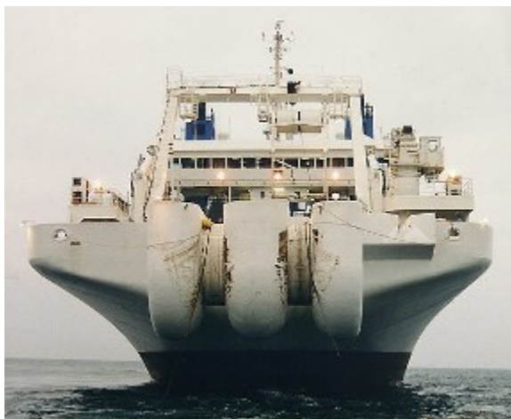
Tengeri kábelfektető hajó
